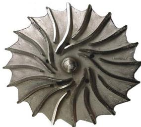
El impulsor semiabierto (abierto) es completamente intercambiable con el de álabes inverso, (ver tamaños compatibles). Es una excelente opción para aplicaciones que requieren alto nivel de esfuerzo constante contra la carcasa y para líquidos que tienden a atascarse, bombeo de líquidos viscosos y otras aplicaciones.
